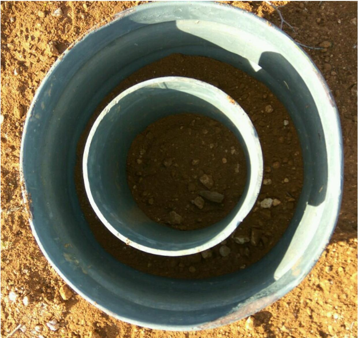
Colocación del segundo anillo y medidor.
